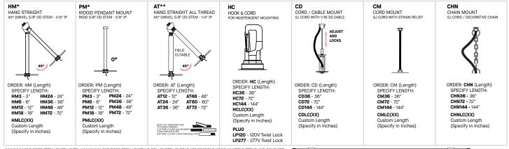
\*MAXIMUM ONE PIECE STEM LENGTH IS 72". \*\*MAXIMUM ONE PIECE STEM LENGTH IS 36". LONGER LENGTHS ARE POSSIBLE USING MULTIPLE STEMS AND COUPLERS.
