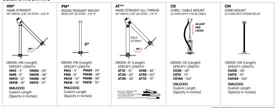
\*MAXIMUM ONE PIECE STEM LENGTH IS 72". \*\*MAXIMUM ONE PIECE STEM LENGTH IS 36". LONGER LENGTHS ARE POSSIBLE USING MULTIPLE STEMS AND COUPLERS.
